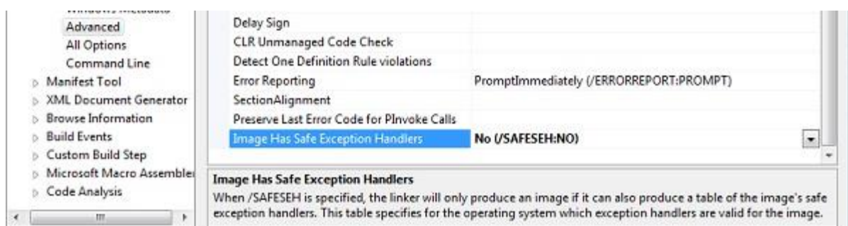
Рисунок 1.13 – Пример настройки параметра компилятора SAFESEH
