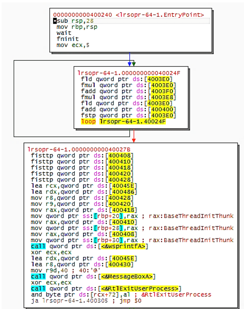
Рис. 4.7.4. Алгоритм (граф) программы в окне отладчика x64Dbg
